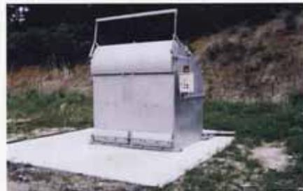
食品残渣に混入されたナイロン・プラスチック等を高温蒸気によって溶解し、体積をおよそ40~50分の1に凝固します。
